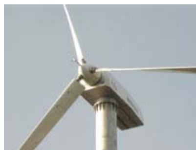
圖 8/運轉中之核研所 25kW 實驗型風力發電機
