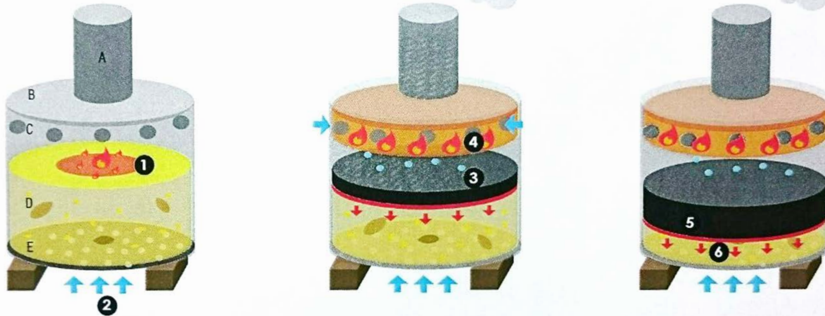
A. 煙囪 B. 鐵桶 C. 3公分孔徑通風口 D. 破碎樹枝、碎木塊等生物質 E. 桶底打8公釐孔徑、間距3公分的洞
